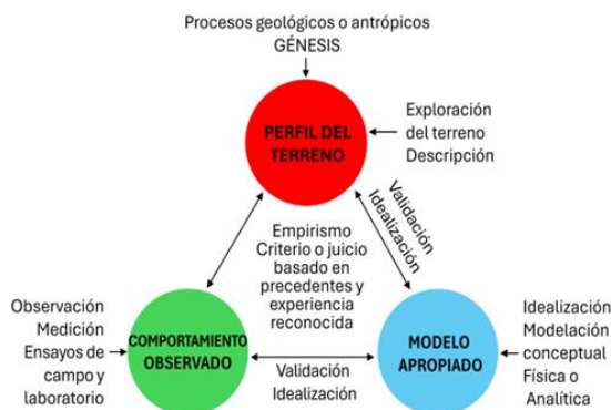
Figura 13. El triángulo geotécnico de Burland (1987-2007)
