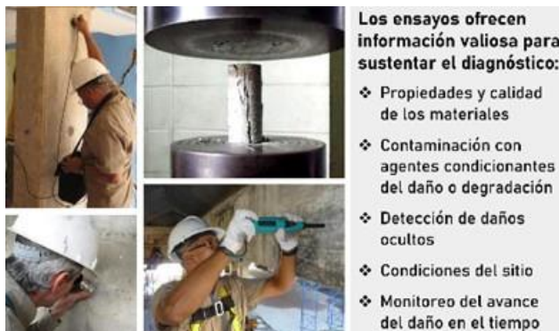
Figura 9. Ensayos más comunes para evaluar estructuras
