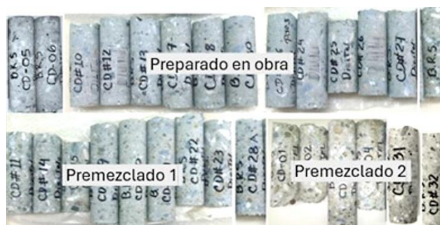
Figura 29. Núcleos de concreto
