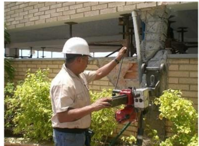
Figura 20. Toma de muestras para evaluación en detalle de un edificio existente afectado por el sismo de Tucacas, 2009
