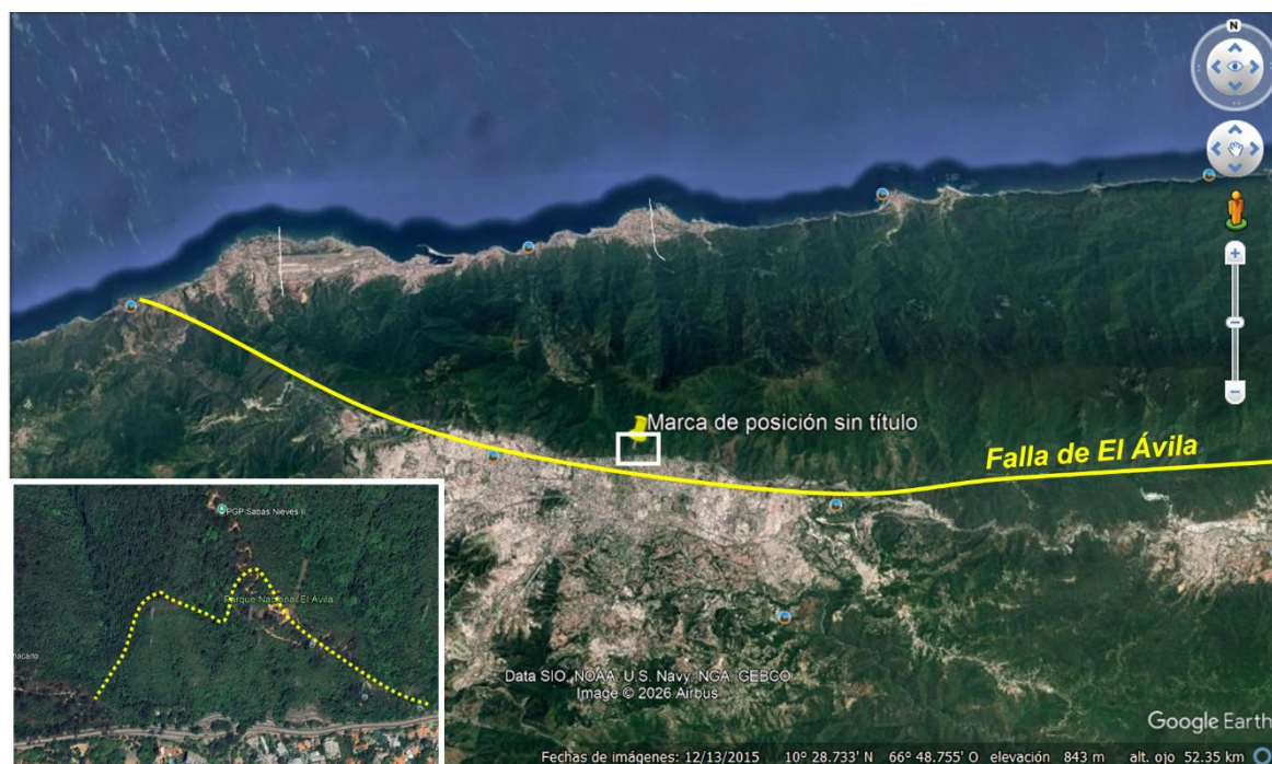
Figura 12. Trazo aproximada de la falla de El Ávila, que limita el relieve abrupto de la cordillera de la Costa del valle de Caracas. Ejemplo de facetas triangulares que se reconocen a todo lo largo de la traza de falla
