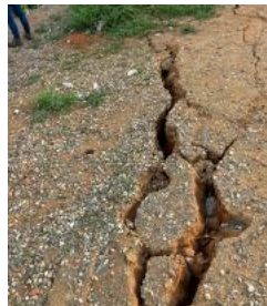
Figura 12.8. Desprendimiento lateral del suelo en el borde del talud, con grietas abiertas en la corona.
