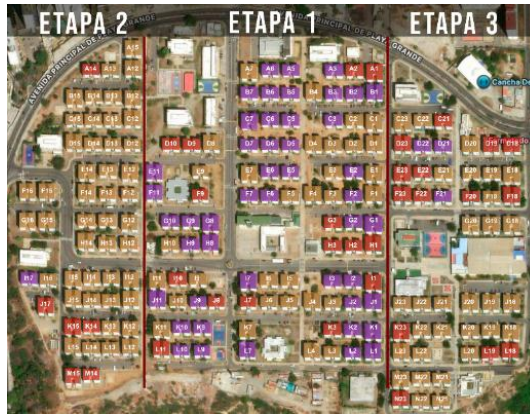
Figura 12.3. Estado de daño de cada edificación, por etapa constructiva. Naranja ■: sin colapso (SC); morado ■: colapso de un nivel (CP); rojo ■: colapso de más de un nivel o incendio (OT).
