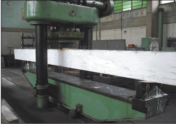
Figura 1. Vista de la prensa y de la vigueta antes de ser ensayada. Ensayo 0.
