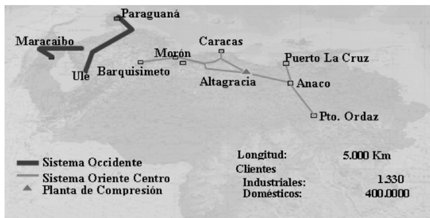
Figura N° 18 - Red de Gasoductos
