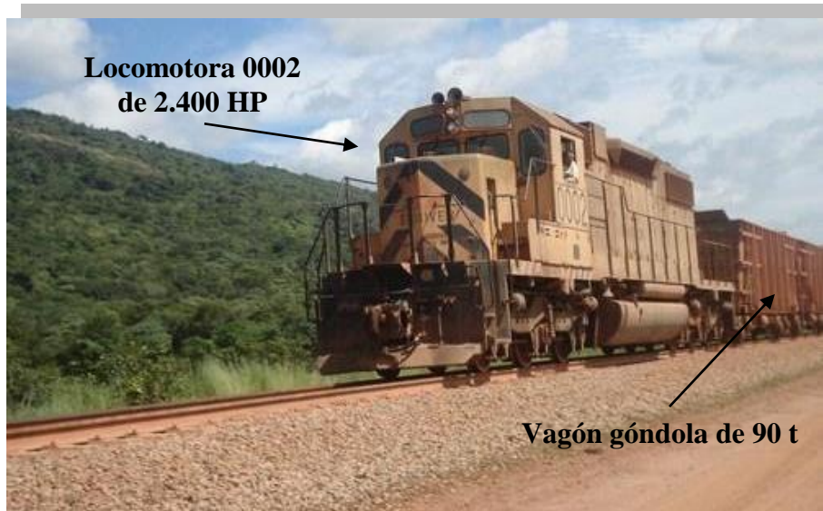
Figura 27. Locomotora de 2400 HP transportando un tren de 28 vagones, con 90 toneladas de carga útil cada uno, es decir, cada tren transporta 2520 toneladas de bauxita promedio. La planificación de la producción estimaba de 5 a 6 trenes, en turnos de 8 horas. Foto autor: CVG Bauxilum.
