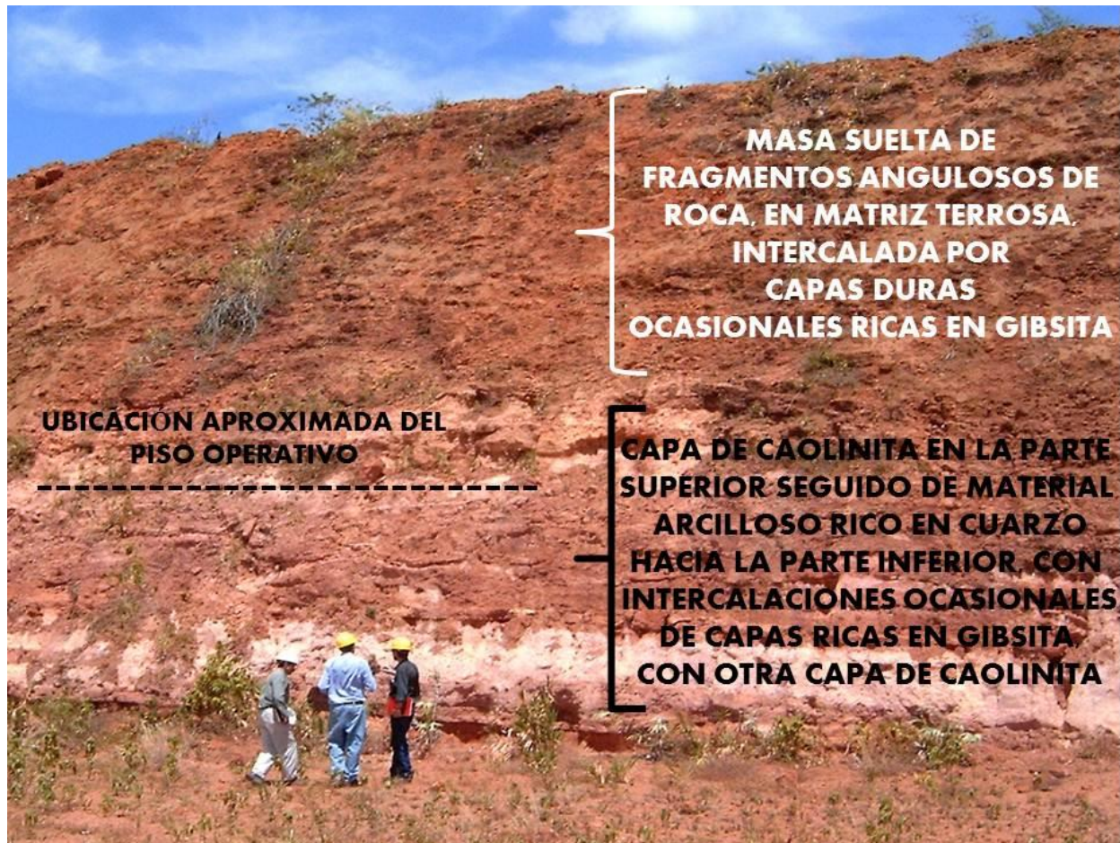
Figura 10. Afloramiento de un frente típico, tomado como ejemplo para el presente trabajo, ubicado en el bloque 3 del yacimiento, para el año 2004. Este sitio ya fue explotado en los años siguientes y se indica la localización aproximada del piso operativo o piso definitivo de explotación. Todo el material por encima de este plano — piso operativo — fue ya extraído y triturado. Foto autor: Noel Mariño, año 2004.
