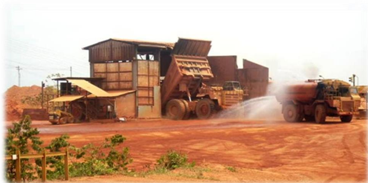
Figura 30. Zona de descarga de los camiones de 100 toneladas, en la planta de trituración, en la mina. A la derecha, se observa un camión ballena, de 45 mil galones de agua de capacidad, para el control de polvo, por medidas de seguridad 17 . Foto autor: Noel Mariño, año 2004.
