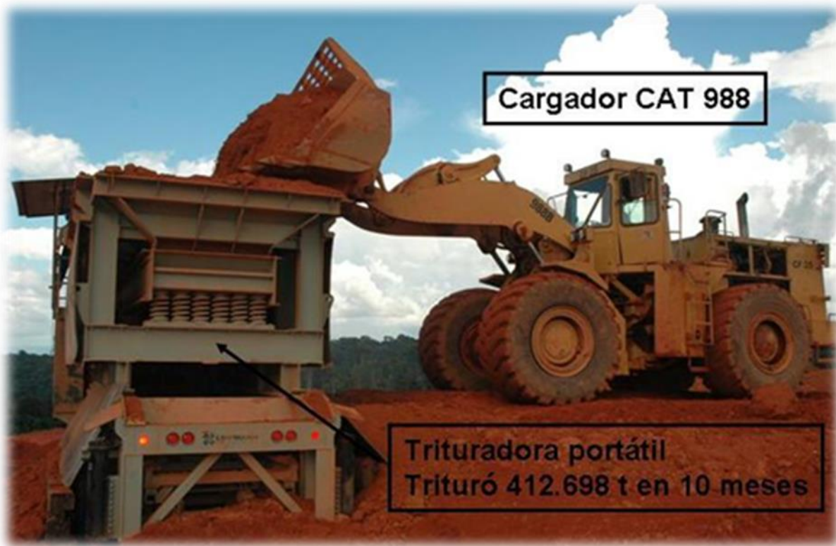
Figura 31. Operación con el triturador portátil 20 y cargador frontal de 6,3 m 3 . Este escenario ya fue probado en campo con éxito, en la emergencia operativa del año 2005, cuando ocurrió el descarrilamiento de la DHC. Foto autor. Noel Mariño, año 2005.
