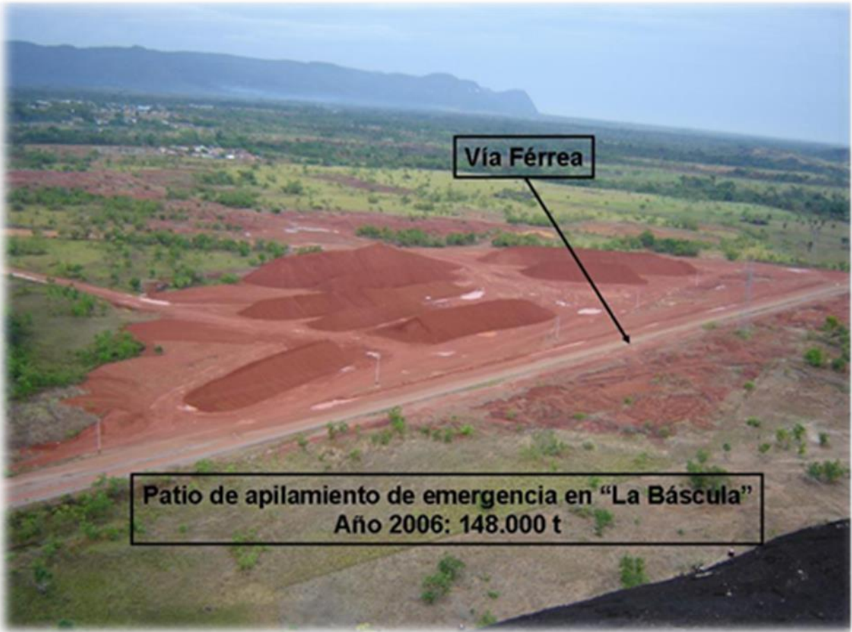
Figura 32. Diversas pilas de bauxita, en el patio de emergencia en “La Báscula”, frente a la vía férrea que comunica el patio de Pie de Cerro con el muelle de El Jobal. La carga de los vagones del tren se realizó en su momento, con un cargador frontal de 6,3 m 3 de capacidad de balde, a través de rampas o muelles de carga ferroviaria. Autor foto: Félix Mariño, año 2006.
