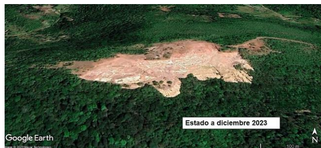
Figura 5 – Imagen satelital de visión lateral del cerro El Chorro, donde se observa la denudación producto de las operaciones de extracción de bauxita, sin remediación ambiental, que genera erosión y aporta flujo de sedimentos a las quebradas de las laderas durante el período de lluvias. Fuente: Google Earth (2022).
