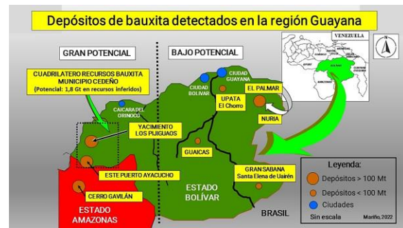
Figura 3 – Ubicación del depósito de bauxita de El Palmar (flecha blanca) en el estado Bolívar, en la zona definida por el autor como “zona de bajo potencial”, con baja alumina y alto hierro con respecto yacimiento bien estudiado de Los Pijiguaos, en el contexto de los otros depósitos de bauxita detectados en la Región Guayana. Sin escala. Fuente: Mariño (2023).
