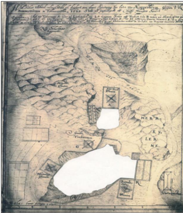
Figura 32. Primer mapa minero de Suecia, elaborado por Olof Hansson Swart en febrero de 1629 de la mina de cobre de Falun, el cual marcó un hito en la cartografía minera. Este mapa destaca porque consta de varias hojas, una para cada nivel de la mina. Los pasos entre los niveles están indicados por los agujeros blancos en el pergamino. Este era un método de representación totalmente nuevo a diferencia del método alemán. Tomado de Ehrensward (2008)
