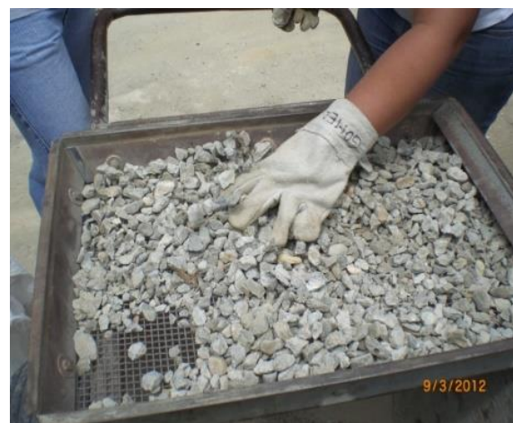
Figura 3. Tamizado del agregado reciclado.
