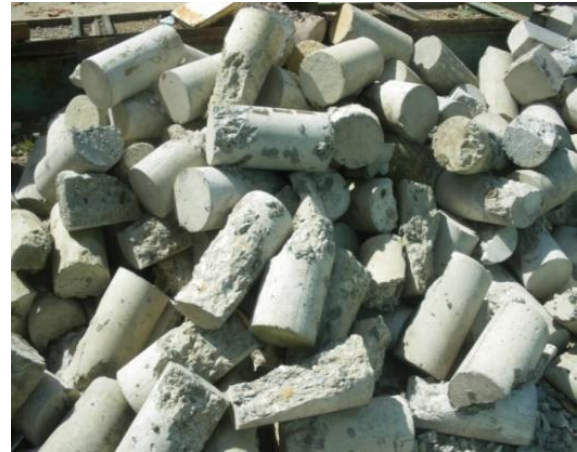
Figura 1. Cilindros que se trituraron para obtener el agregado reciclado.
