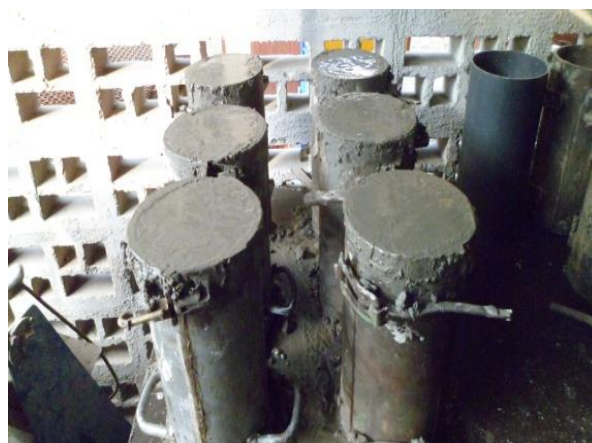
Figura 5. Cilindros vaciados en sus moldes.
